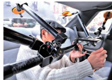
↑走行中の振動でカメラがブレるため、念入りに固定する必要がある。映像機材のレンタル業務などを行なう専門業者が約2時間掛けて固定作業を実施している
